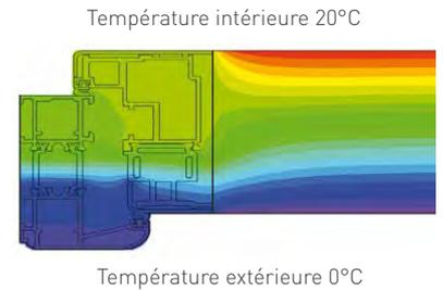
**Thermique** : calcul réalisé selon la norme EN ISO 10077-1 et -2 sur porte pleine avec dimension d'ouvrant de 2350 x 1070 mm et rejet d'eau. **AEV** : essais réalisés selon la norme NF P 20-501. N°404/2019/243-1 du 06/12/2019. **Ensoleillement** : selon norme NF EN 12219. **Acoustique** : Classification selon la norme ISO 717-1 sur porte pleine de dimension HT 2180 x 960 mm.
