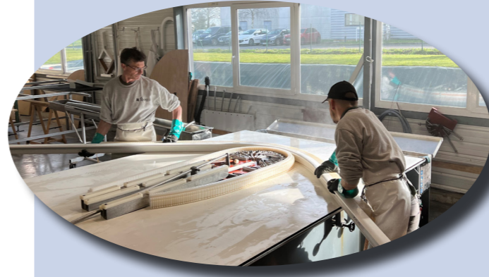
Cintrage en cours dans notre atelier
